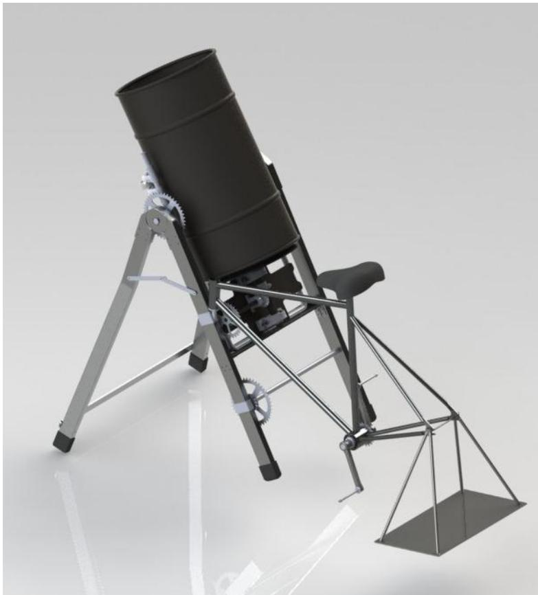
*Figura 4.95: Vista isometrica della betoniera con il sistema del secondo disegno*
