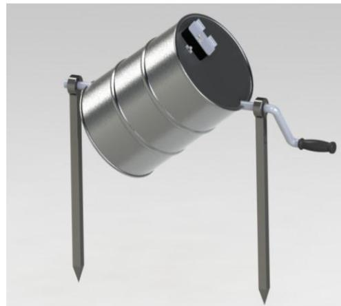
*Figura 3.10: Disegno in solidworks di una miscelatrice manuale*
