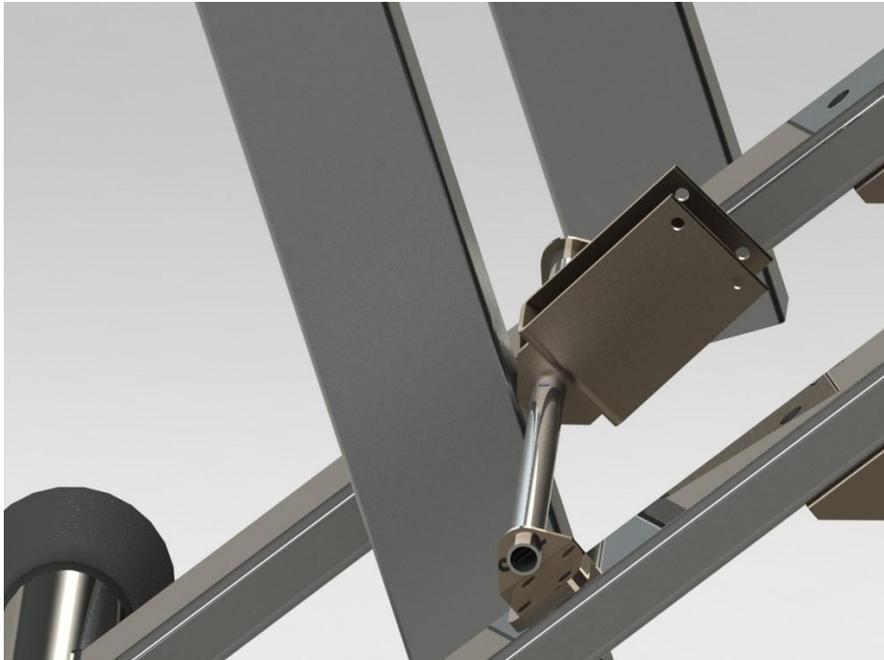
*Figura 4.106: Vista di dettaglio del sistema d'attacco sbloccato*
