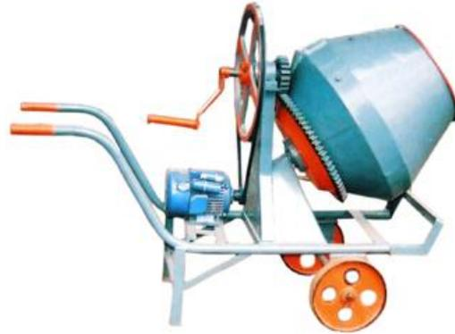
Figura 3.15: Esemplio di betoniera manuale e elettrica
