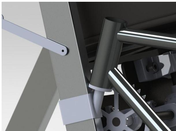
*Figura 4.97: Vista di dettaglio dell'attaccamento bicicletta-betoniera*
