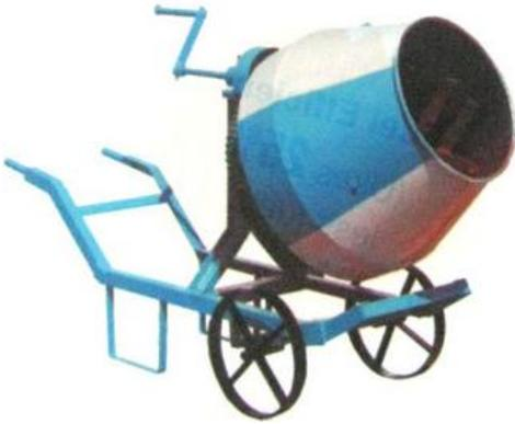
Figura 3.14: Esemplio di betoniera manuale
