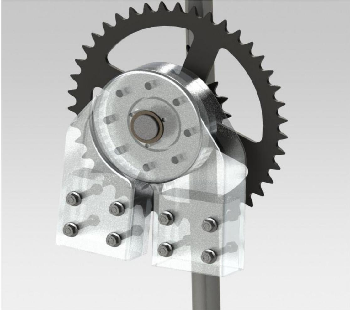
*Figura 4.80: Montaggio cerniera di scala e insieme ruote dentate con le gambe chiuse*
