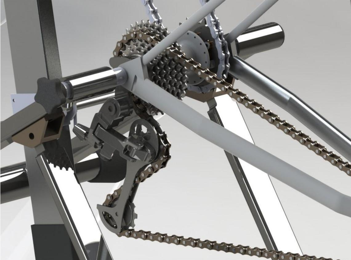
*Figura 4.103: Vista di dettaglio del mozzo posteriore della bicicletta con il sistema di ruota libera*
