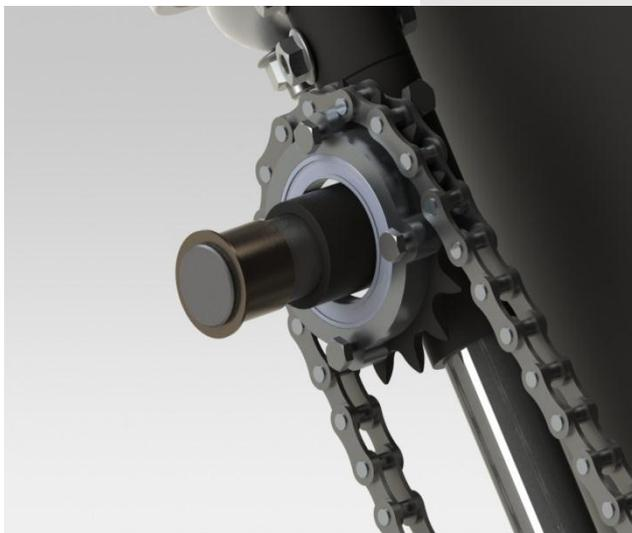
*Figura 4.31: Vista di dettaglio del pignone centrale*
