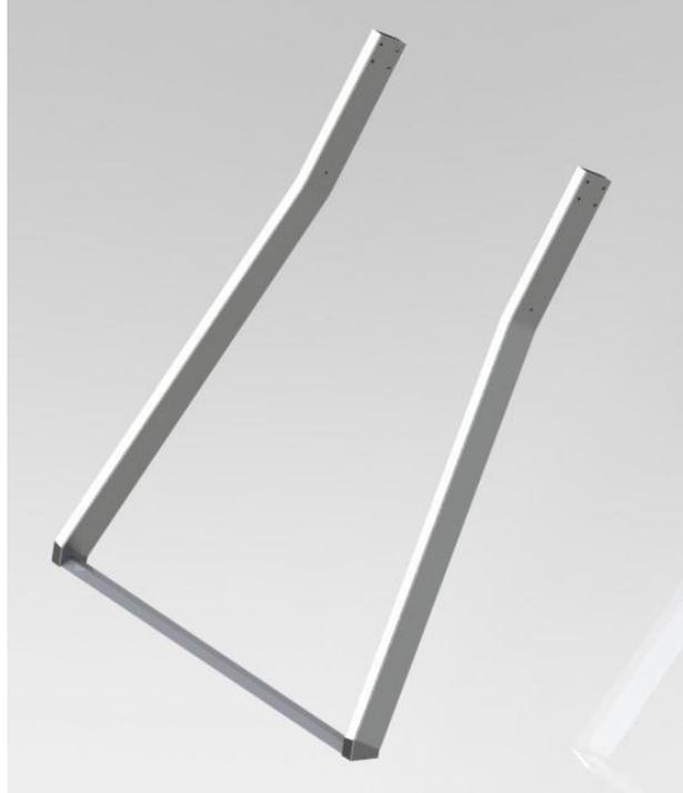
*Figura 4.85: Montaggio delle due gambe anteriori*
