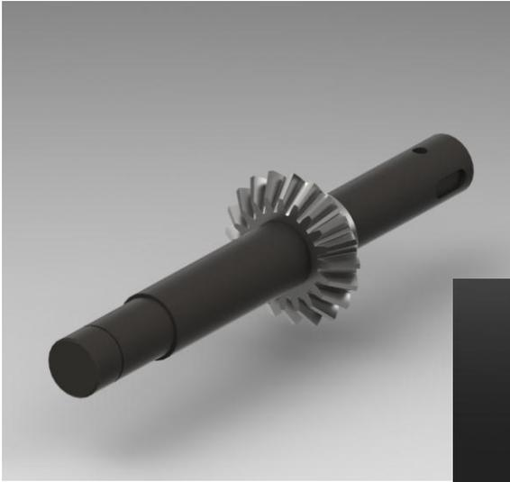
*Figura 4.51: Vista isometrica del montaggio assebidone-ingranaggio*
