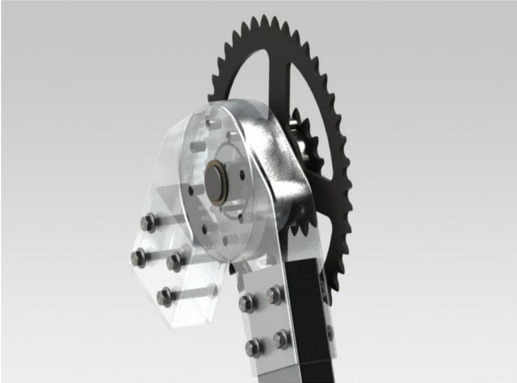
*Figura 4.78: Montaggio cerniera di scala e insieme ruote dentate – vista anteriore*
