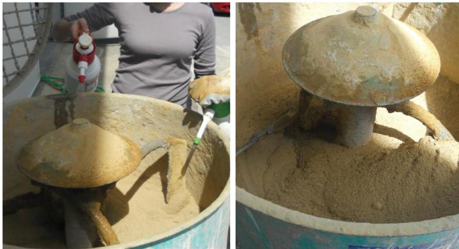
*Figura 3.11: Esempio di miscelatrice elettrica*
