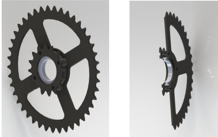
Figura 4.70: Vista isometrica e in sezione del montaggio centrale
