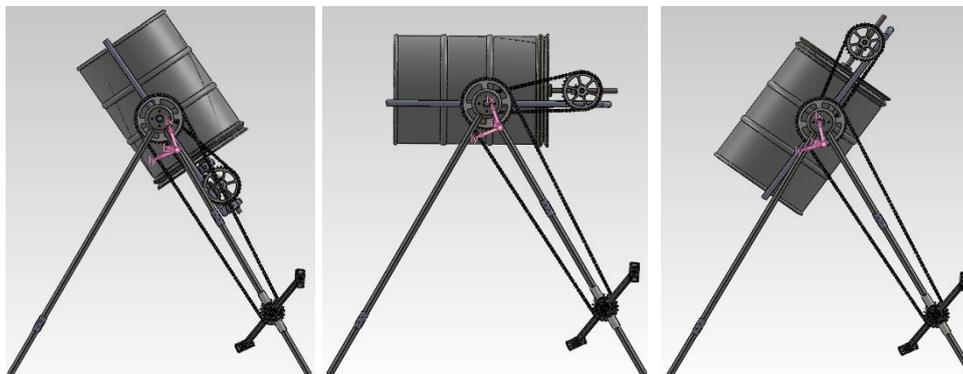
Figura 4.19: Centro di gravità, movimento di svuotamento
