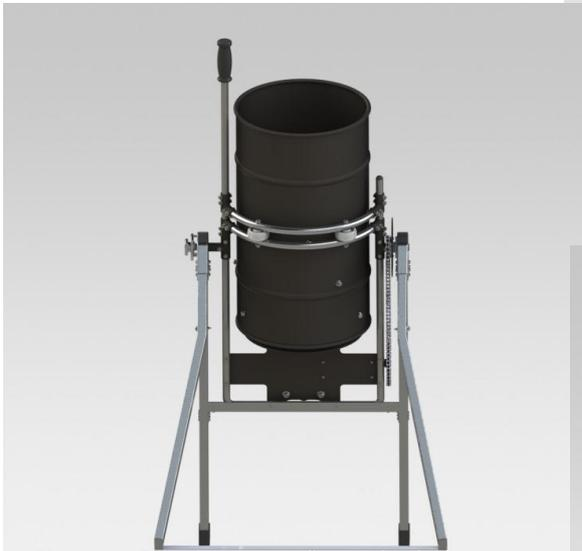
*Figura 4.25: Prospetto frontale della betoniera*
