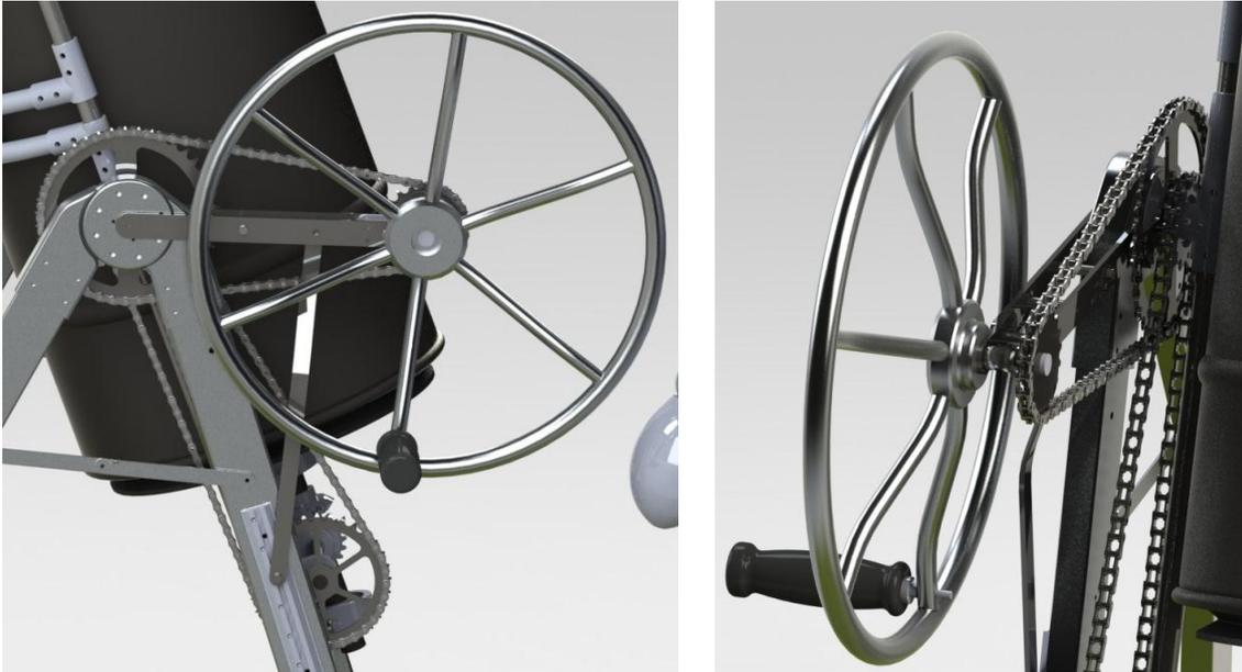
*Figura 4.111: Vista di dettaglio della trasmissione*
