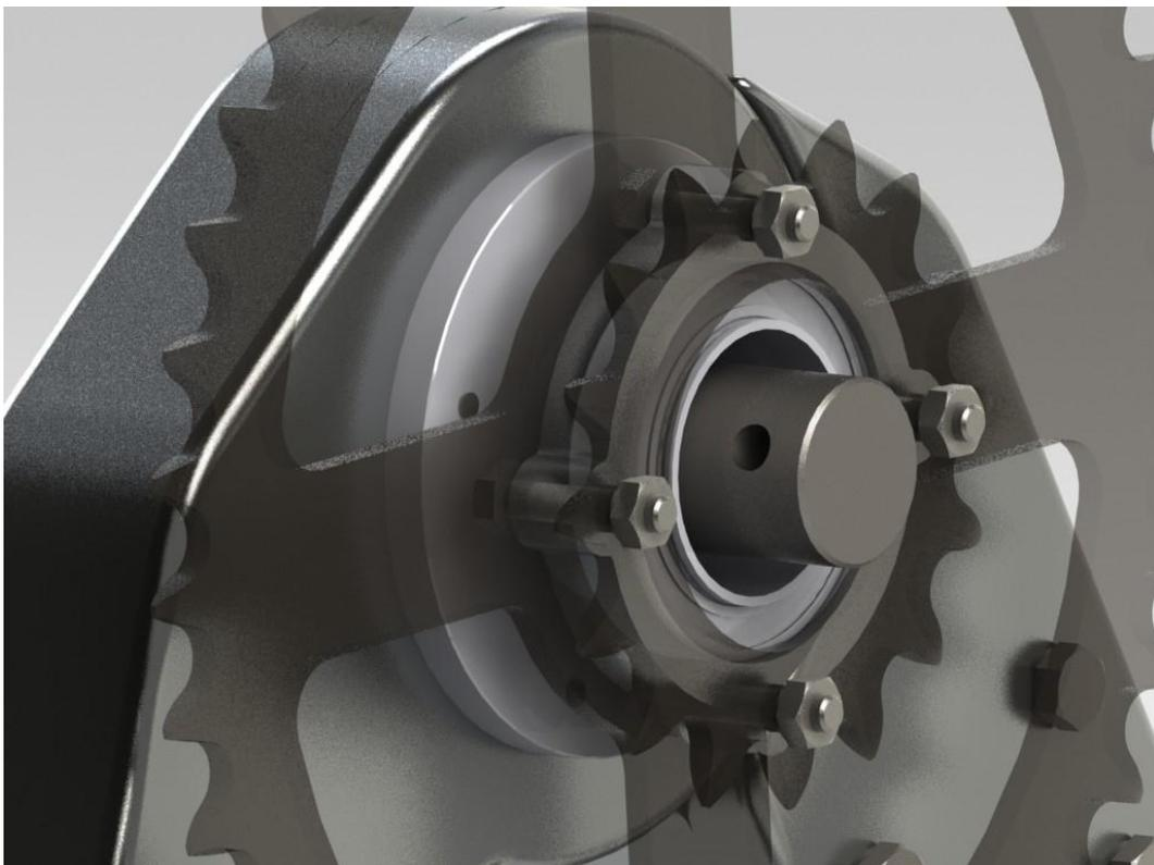
*Figura 4.79: Montaggio cerniera di scala e insieme ruote dentate – vista posteriore*
